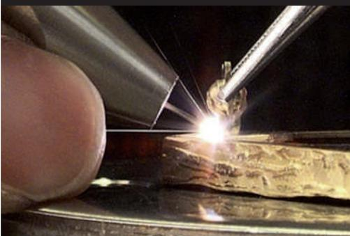
*Die präzise Positionierung der Schweisspunkte wird durch das Aufsetzen der Elektrodenspitze ermöglicht. Der zum Schweissen notwendige Lichtbogen wird exakt vom Berührungspunkt ausgehend erzeugt.*
