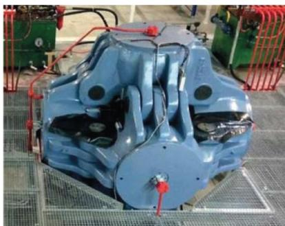
Der Diamant wächst in der Hochtemperatur-Hochdruckpresse bei 1`800 Grad und 70`000 bar Druck.
