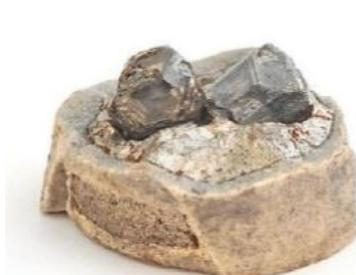
Nach dem Öffnen der Wachstumszelle wird der Diamant gereinigt und zum Schleifen vorbereitet.
