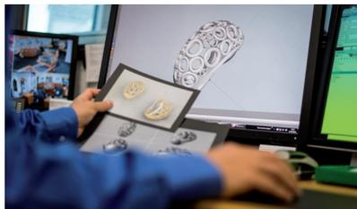
Handskizzen bilden die Grundlage für das CAD-Modell und die 3D-Visualisierung. Die einzelnen Teile des Schmuckstücks werden danach an den 3D-Drucker übermittelt.
