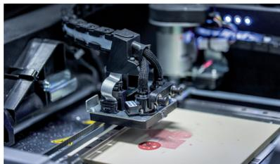
Hier entsteht der Rohling in vielen Schichten für die Weiterverarbeitung. Dieser Prozess kann bis zu zwanzig Stunden dauern.
